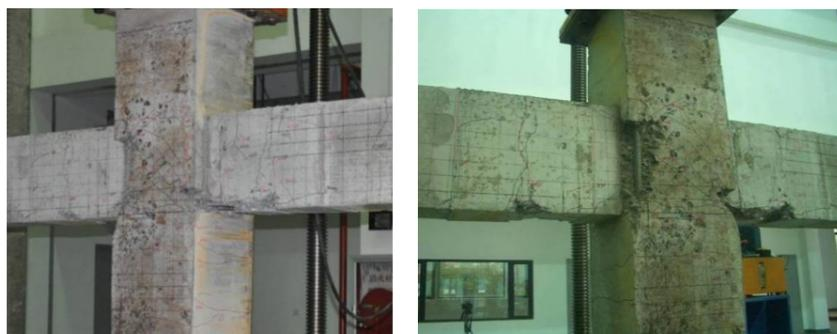
图 13 实测节点 1 主要裂缝分布
