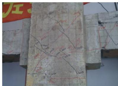
图 41 实测节点核心区开裂
