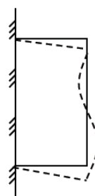
(c) Actual shear deformation
